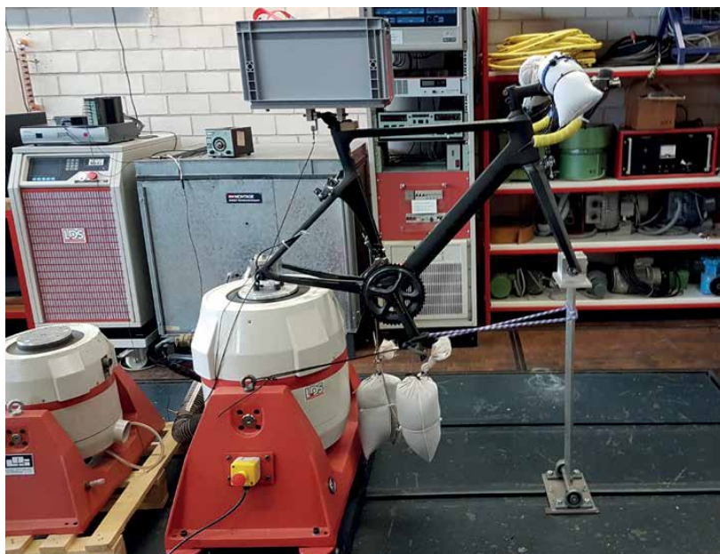
Abb. 1: Versuchsaufbau Shaker: Rennradrahmen mit Schwabbelmassen und Messtechnik
