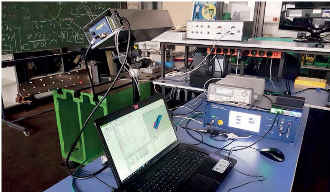
Abb. 2: Versuchsaufbau automatisierte experimentelle Modalanalyse an einer einseitig eingespannten Turbinenschaufel: Anregung über Elektromagnet, Verstellung des Lasermessstrahls mit Kreuzspiegel
