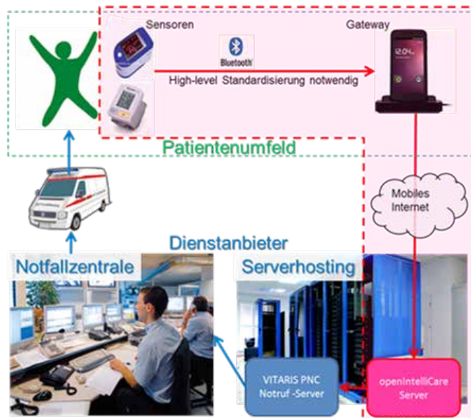
Abbildung 2: Aufbau von openIntelliCare
