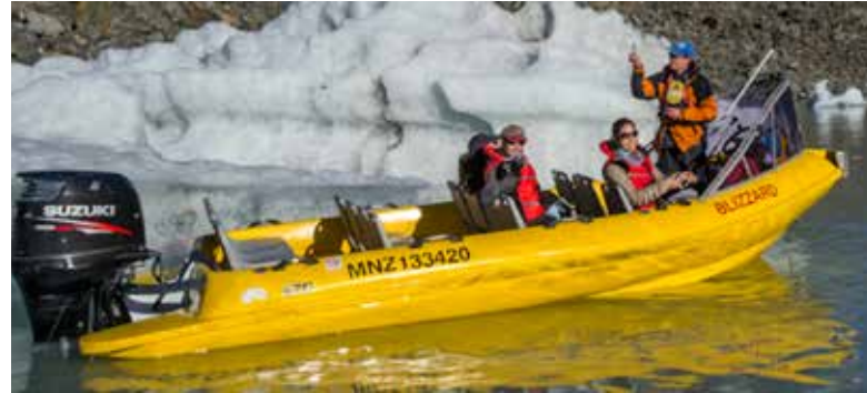
Bild 1: Rotationsgeformtes Boot der Fa. Galloway
