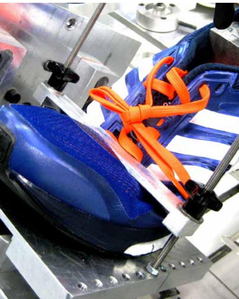
Abbildung 2: Testapparatur zur Bestimmung der Biegesteifigkeit von Schuhen. Das Gerät ist ein spezieller Eigenbau des PFI. (Bildquelle PFI)
