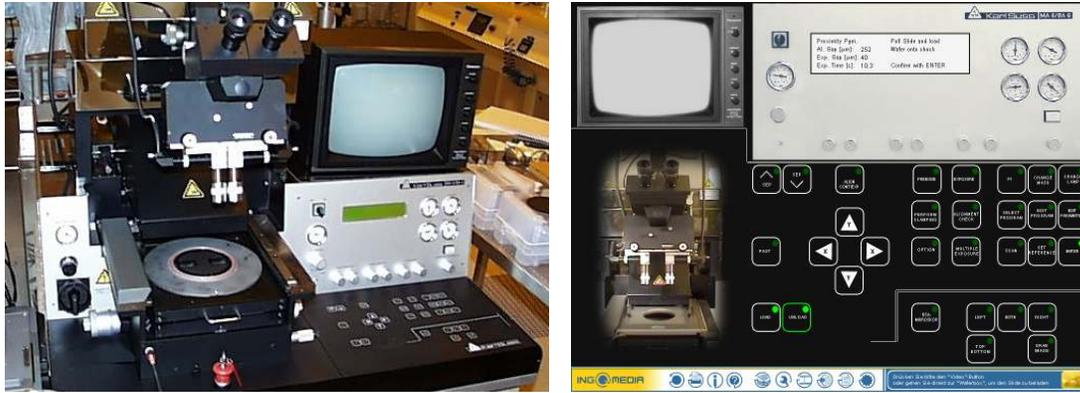
Abb. 5: Reale Anlage Mask Aligner (links) und Oberfläche der virtuellen Maschine (rechts)
