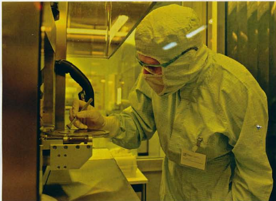
Lotta Emilia Delle bei der Arbeit an der Nano-Imprint Anlage. Sie ist auf die Herstellung der Nanostrukturen spezialisiert.
