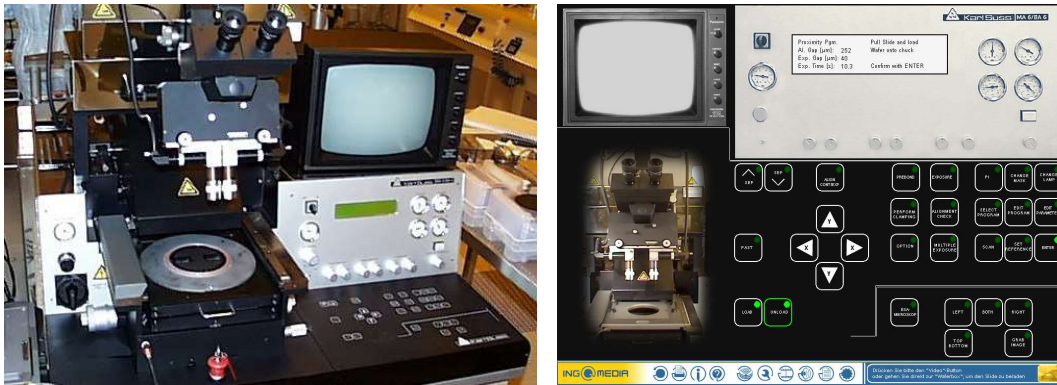
Abb. 6: Reale Anlage Mask Aligner (links) und Oberfläche der virtuellen Maschine (rechts)
