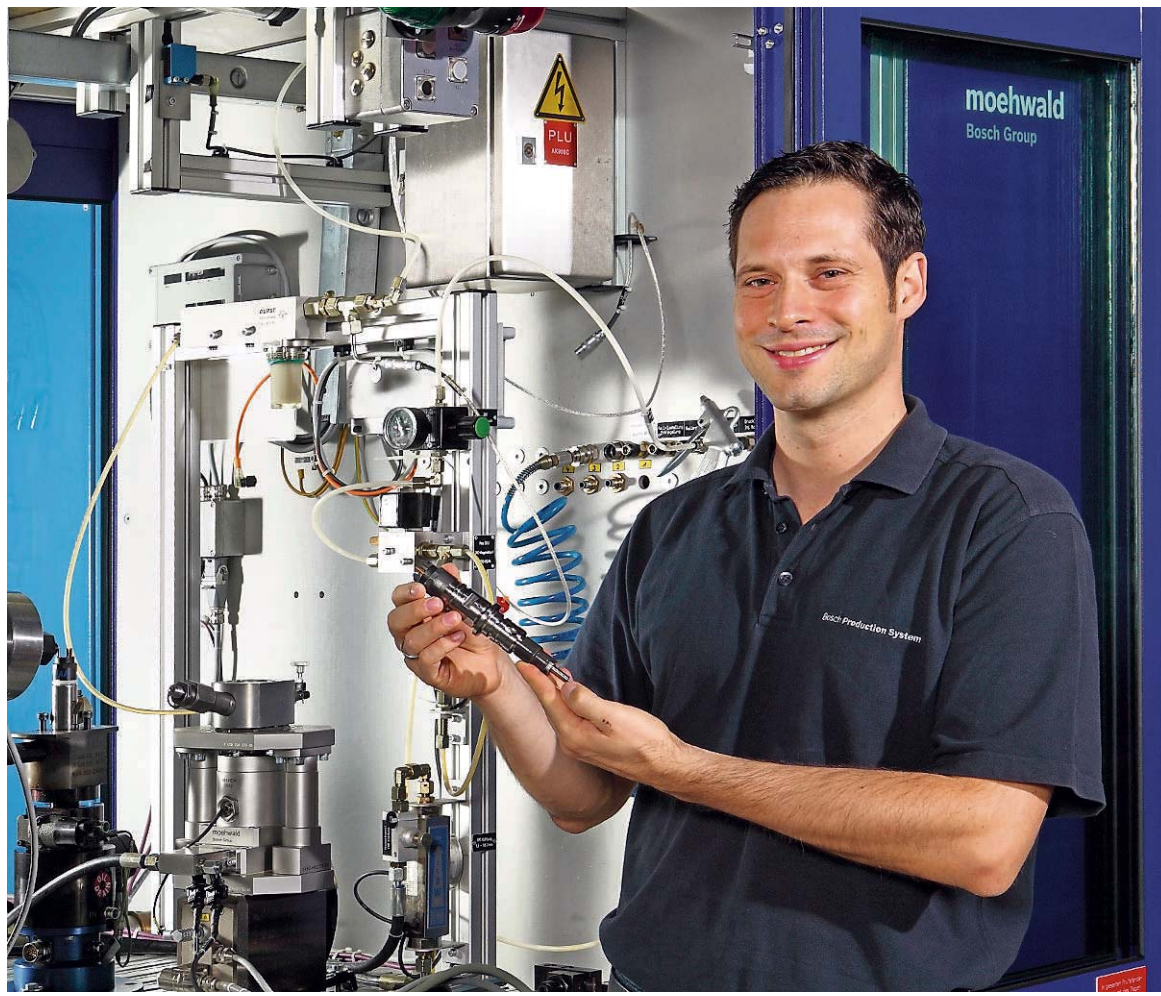
Manuel Dasch steht am Universal-Funktionsprüfstand für Common-Rail-Komponenten. FOTO: BOSCH
