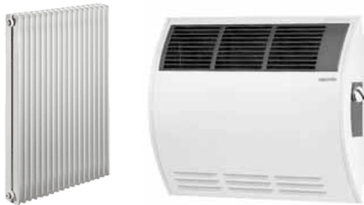
Abb. 2.2.2.1.2.e – Links ein Heizkörper, rechts ein Konvektor: In Inneren ist ein Heizkörper und ein Lüfter um die erwärmte Luft schnell zu bewegen.
